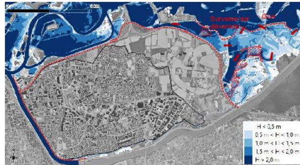
Figure 4 : Carte de hauteur d'eau – scénario 1a – Fonctionnement nominal à Q200
