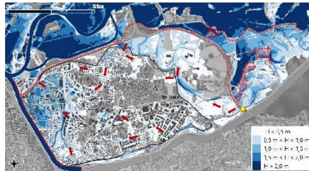
Figure 13 : Carte de hauteur d'eau - scénario 3c - Défaillance du pertuis de fond de la Rize à Q200
