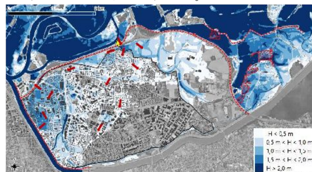
Figure 16 : Carte de hauteur d'eau – scénario 3f – Rupture de la Digue Duclos à Q500
