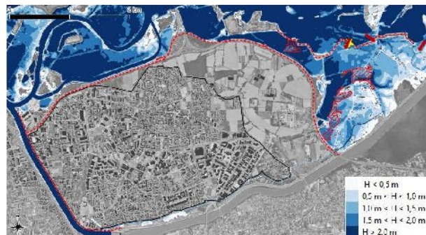
Figure 12 : Carte de hauteur d'eau - scénario 3b - Rupture des Eaux Bleues à Q200
