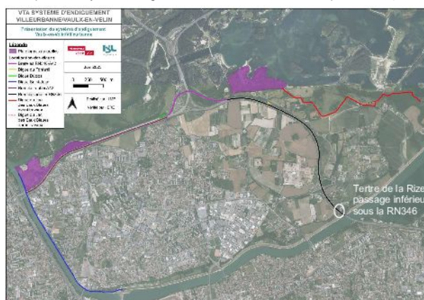
Figure 1 : Composition du système d'endiguement avec ses éléments annexes
