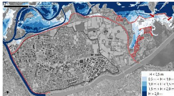
Figure 6 : Carte de hauteur d'eau - scénario 1b - Fonctionnement nominal à Q30
