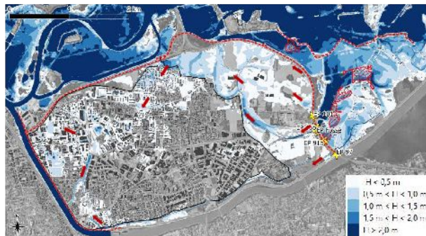
Figure 9 : Carte de hauteur d'eau - scénario 2b - Défaillance de fermeture des ouvrages traversants à Q200
